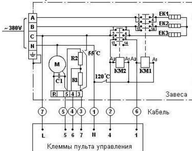
Рис. 4. Электрическая схема КЭВ-6П201, КЭВ-9П201
